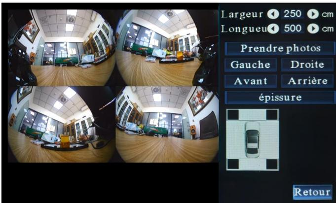
Renseigner largeur : Il s'agit de la largeur entre les bords gauche et droite des tapis de calibrage, et non de la largeur réelle du véhicule.
