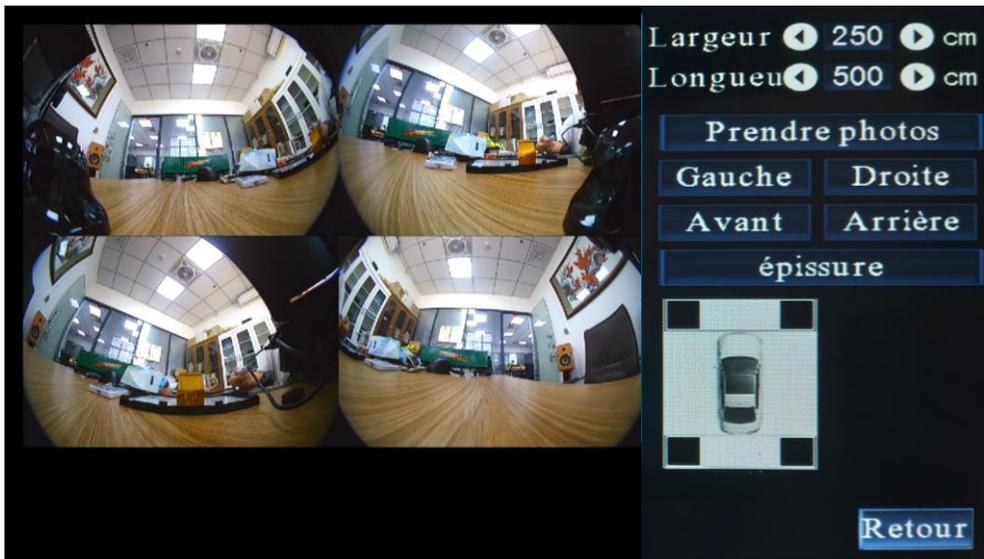
Avant de cliquer sur "Prendre photos", vérifier le placement des tapis de calibration, et le système prendra des photos. A ce stade les tapis de calibration peuvent être retirés, puis cliquez sur "Gauche", "Droite", "Avant" et "Arrière". Pour ajuster l'emplacement du point de calibration. L'ordre des points de calibration est le même pour les quatre caméras : 1-2-3-4 d'en haut à gauche à en haut à droite, et 5-6-7-8 d'en bas à gauche à en bas à droite.
