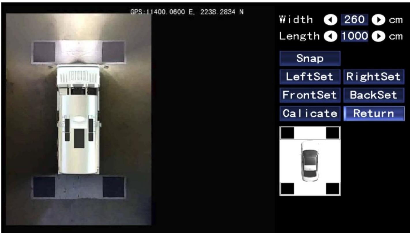
La fonction "Réglage fin Panorama", et Ajustement d'image unique" permet d'affiner le réglage de l'image, en ajustant la translation, la courbure, et le zoom de chaque vue.
